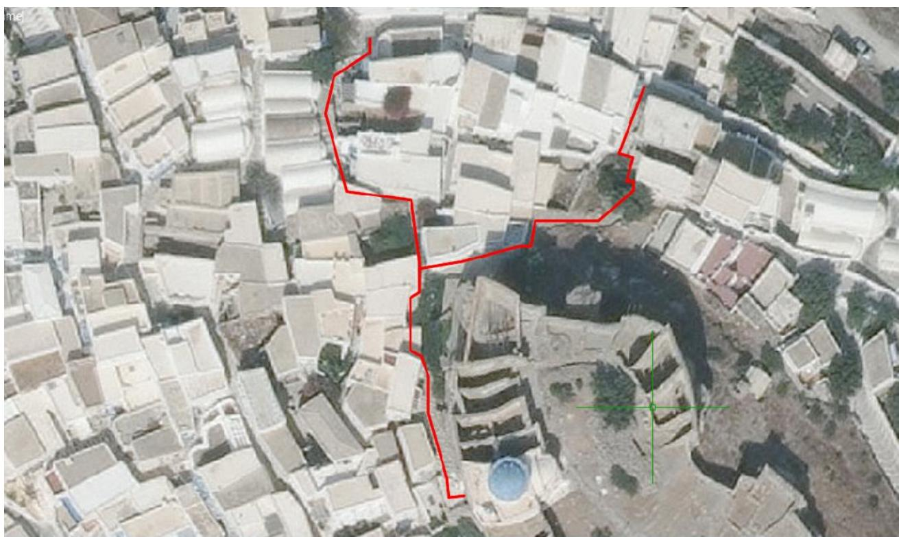
Το έργο αφορά την επισκευή – αρμολόγηση λιθόστρωτων σκαλιών παραδοσιακής μορφής συνολικού μήκους περίπου 160–180 μέτρων, καθώς και την κατασκευή ή αποκατάσταση επιμέρους φθαρμένων ή ελλιπών σκαλοπατιών συνολικού μήκους 30 μέτρων.
